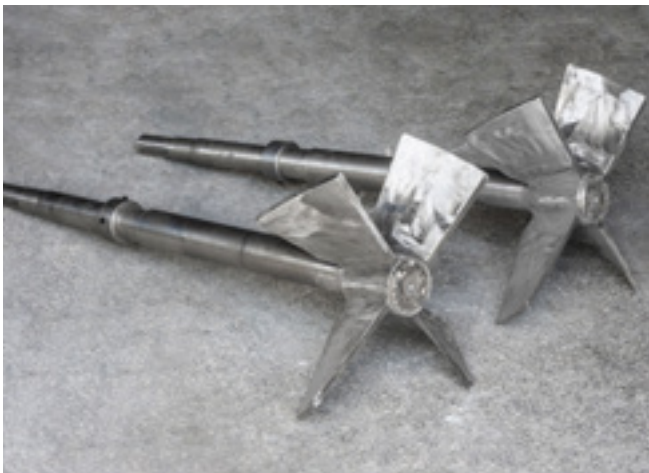
淬火炉风扇 Quenching furnace fan
